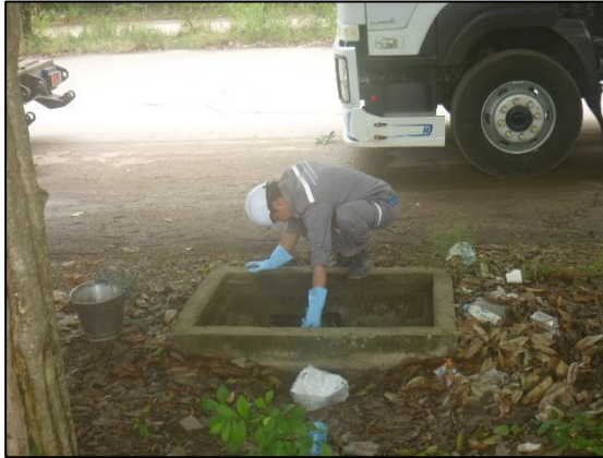
รูปที่ 3.10 การเก็บตัวอย่างคุณภาพน้ำทิ้ง บริเวณบ่อพักน้ำทิ้งหลังผ่านระบบบำบัดน้ำเสียสำเร็จรูป
