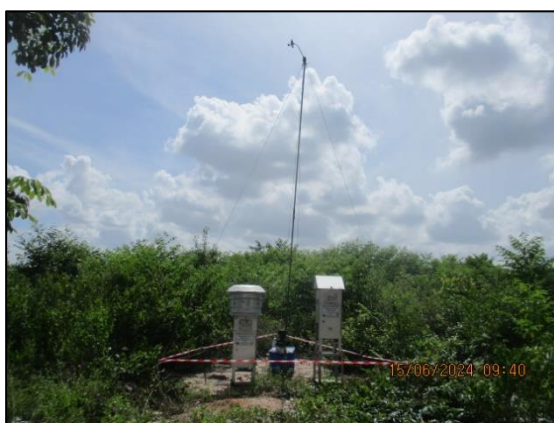
รูปที่ 3.2 การเก็บตัวอย่างคุณภาพอากาศในบรรยากาศ บริเวณที่พักอาศัยด้านทิศใต้ของโครงการ (A2)
