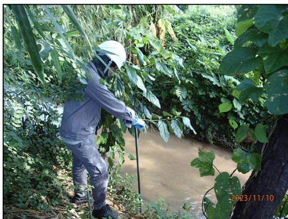
รูปที่ 3.21 การเก็บตัวอย่างโลหะหนักในตะกอนดิน บริเวณคลองข้างต่ายจตุระบายน้ำทิ้งของโครงการ (SD2)
