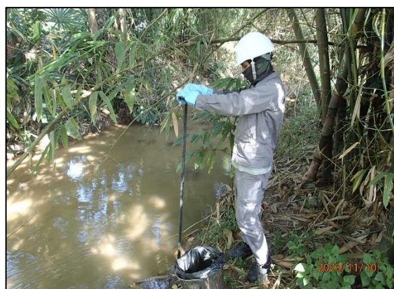
รูปที่ 3.20 การเก็บตัวอย่างโลหะหนักในตะกอนดิน บริเวณคลองข้างต่ายก่อนจุดระบายน้ำทิ้งของโครงการ (SD1)
