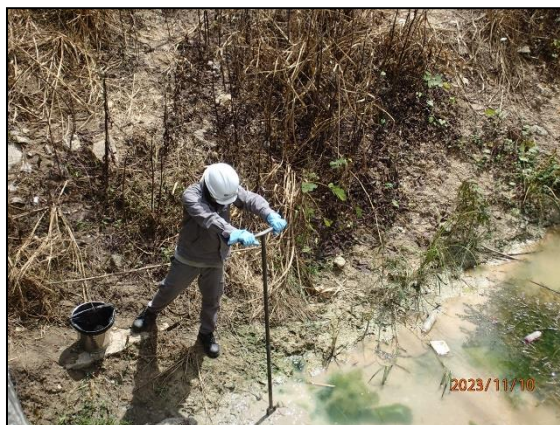
รูปที่ 3.22 การเก็บตัวอย่างโลหะหนักในตะกอนดิน บริเวณคลองข้างต่ายบริเวณทางหลวงแผ่นดินหมายเลข 3143 (SD3)
