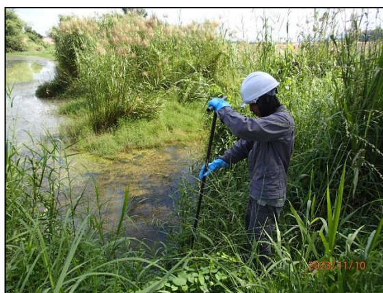
รูปที่ 3.23 การเก็บตัวอย่างโลหะหนักในตะกอนดิน บริเวณคลองกะแมวก่อนผ่านบริษัท จี สตีล จำกัด (มหาชน) (SD4)
