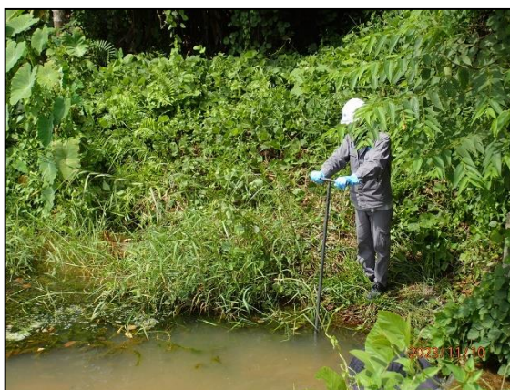
รูปที่ 3.24 การเก็บตัวอย่างโลหะหนักในตะกอนดิน บริเวณคลองกะแมงหลังผ่านบริษัท จี สตีล จำกัด (มหาชน) (SD5)
