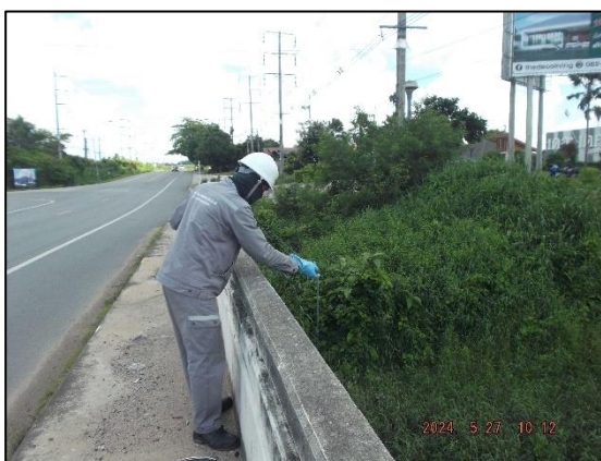
รูปที่ 3.13 การเก็บตัวอย่างคุณภาพน้ำผิวดิน บริเวณคลองข้างต่ายบริเวณทางหลวงแผ่นดินหมายเลข 3143 (SW3)
